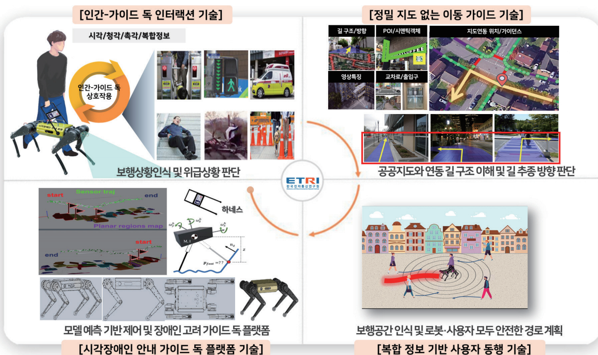
〈그림 2〉 가이드 독: 시각장애인 길 안내 로봇의 기술 구성 [5]
