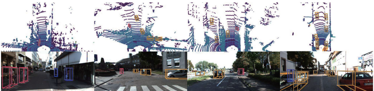
〈그림 2〉 포인트 클라우드 데이터를 입력 받는 PointPillars를 이용한 객체 검출 결과 예시. 〈출처:[3]〉
