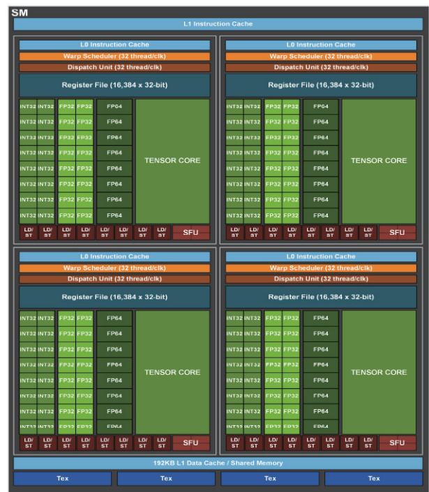
〈그림 3〉 GA100 Streaming Multiprocessor (SM)
