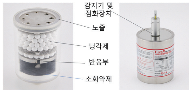
〈그림 6〉 고체에어로졸소화기의 구조
