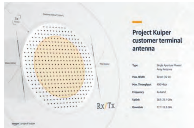
〈그림 17〉 Kuiper 위성 단말 안테나 형상
