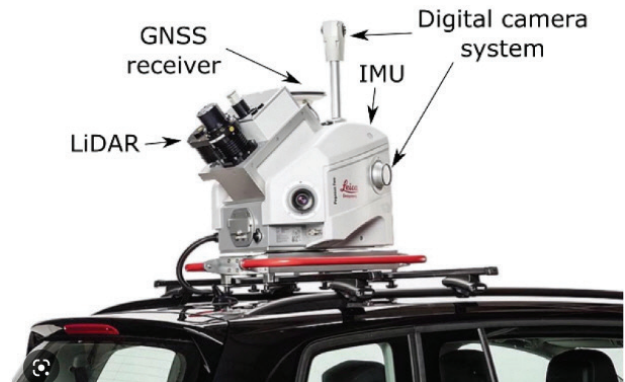
〈그림 3〉 지도 제작 차량에 탑재되는 장비(MMS)
