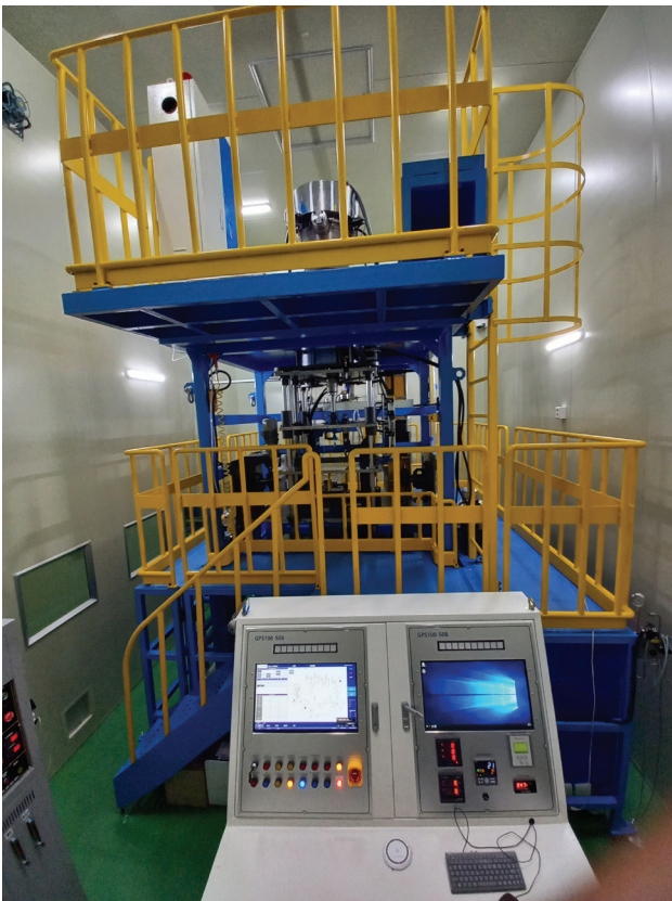
〈그림 1〉 고압성장이 가능한 III-V족 화합물 반도체 단결정 성장장치 (VB법) [㈜삼양세라텍]
