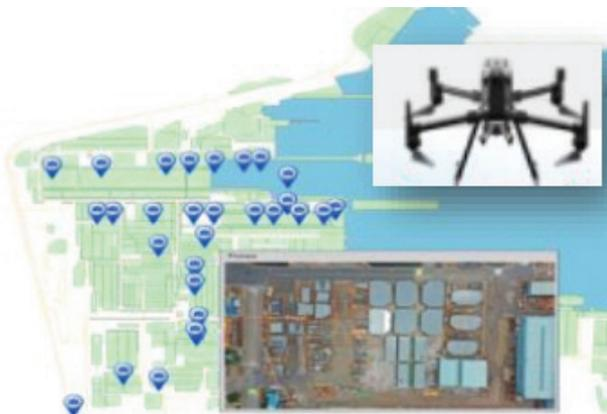
〈그림 22〉 드론을 이용한 소형 블록들의 현 위치 파악
