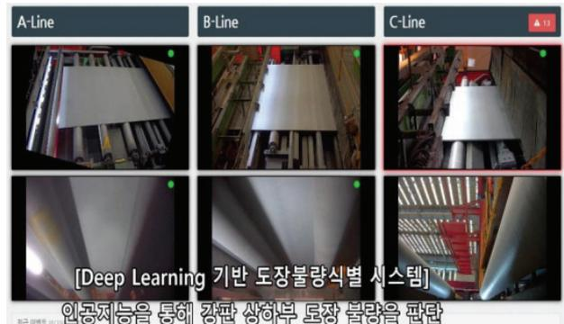
〈그림 19〉 CNN AI를 활용한 철판 도장품질 검사장치
