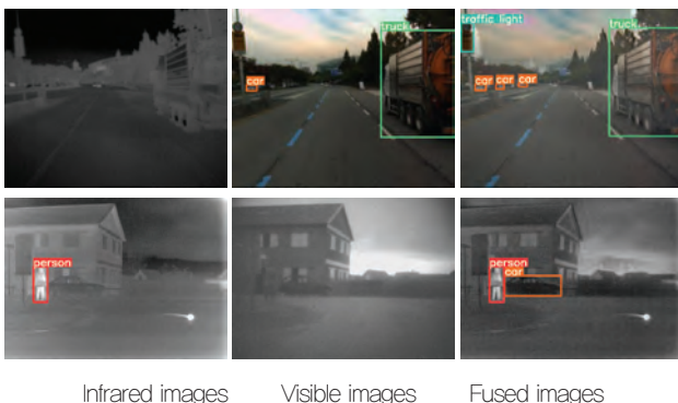
〈그림 2〉 적외선 및 가시광선 영상 합성을 이용한 객체 검출 성능 예시 [3]
