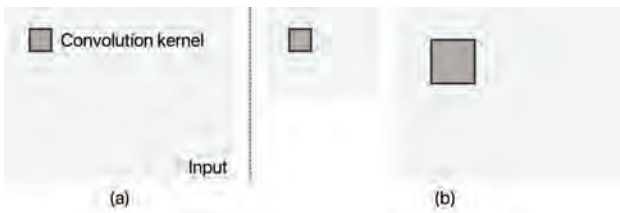
〈그림 4〉 입력의 공간해상도와 컨볼루션 필터의 크기에 따른 컨볼루션 계층의 수용 영역 변화 예시. 같은 컨볼루션 필터 크기를 가지더라도 입력의 공간해상도가 절반인 (b)는 (a)보다 더 큰 수용 영역을 가진다.
