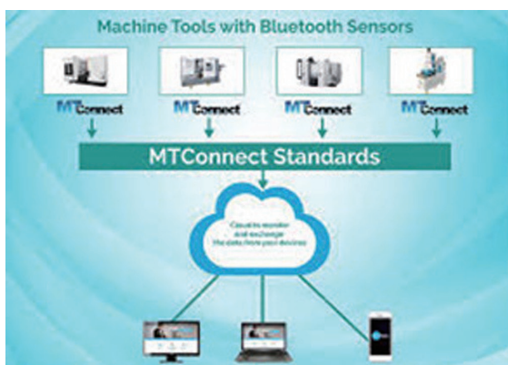
〈그림 14〉 장비간 통신방법(좌:MTConnect 우:OPC-UA)
